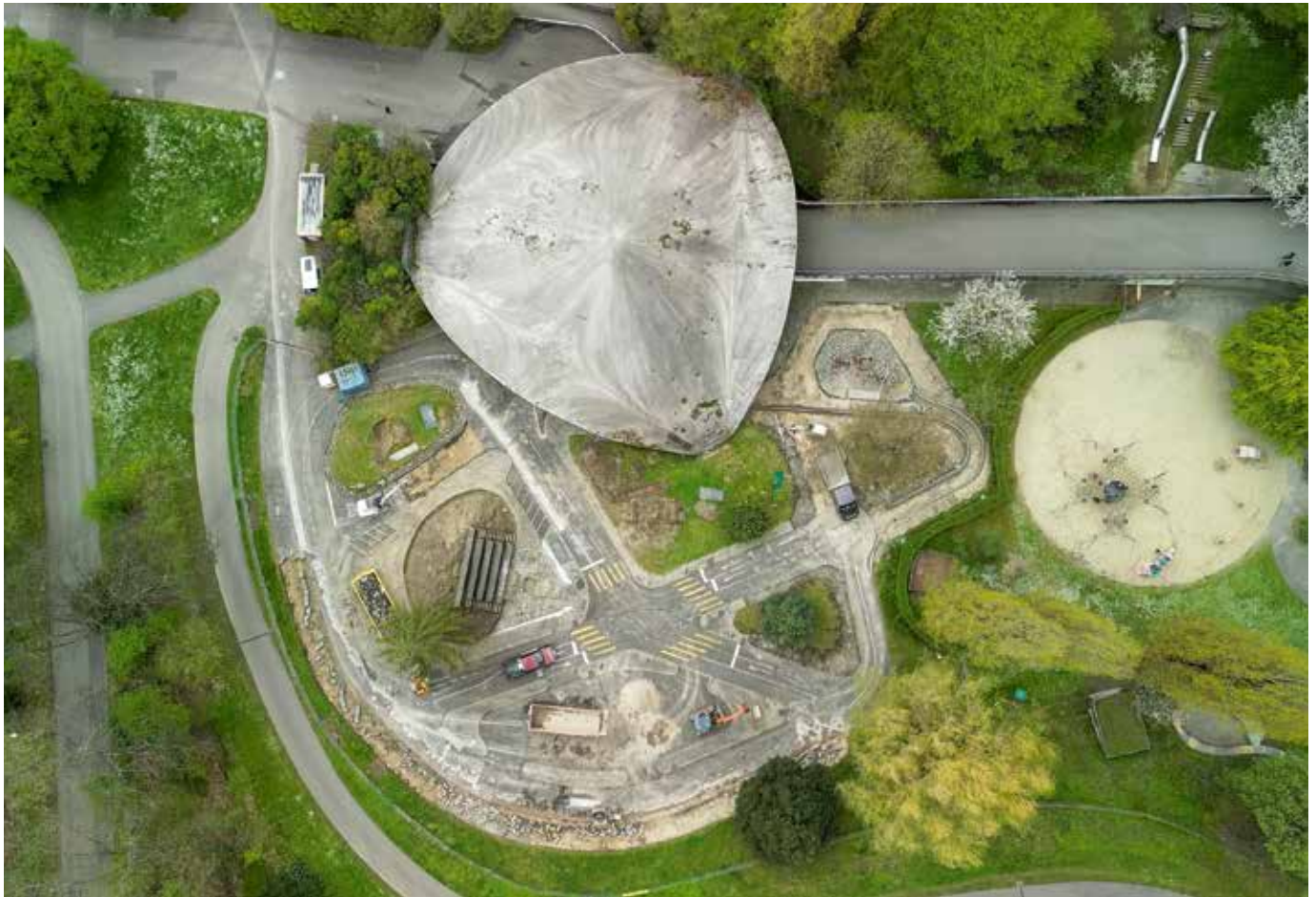
Jardin de circulation, Jardin de pluie. Créé pour l'Expo 64 à la Vallée de la Jeunesse, le lieu sert depuis à former les enfants aux règles de la circulation routière. Dans le cadre de Lausanne Jardins, le site a opéré sa mue: réajustement des pentes du terrain, création de noues et d'un étang, dégrappage, changement d'albédo, plantations diverses, et déconnexion des grilles de collecte d'eaux pluviales. Équipe conceptrice: Paola Viganò, Tommaso Pietropolli, Loan Laurent (HRC-EPFL), avec la collaboration de Luca Rossi (VSA), Murielle Thomet (Hydrique Ingénieurs), Zoé Daeppen (Service de l'eau, Ville de Lausanne), Jérôme Pellet (N+P biologie)
